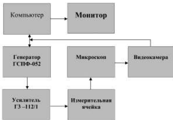
Рис 1. Функциональная схема электрооптической системы детекции измерения величины поляризуемости.
