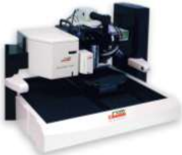
Настольный наноиндентор на открытой платформе с нано-скретч тестером, АФМ и оптическим микроскопом
